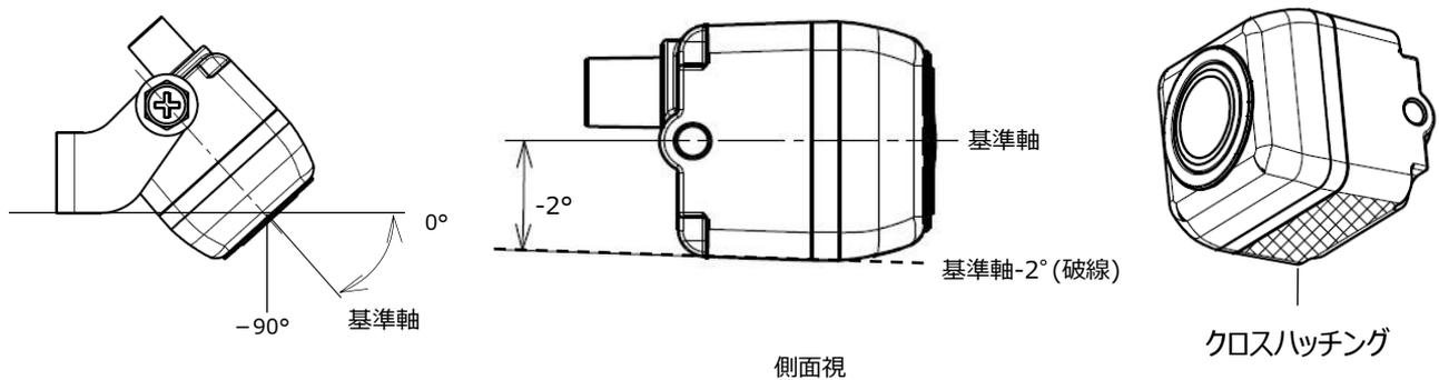
取り付け時の角度測定は、右上図のクロスハッチング部に角度計を当てて行ってください。
