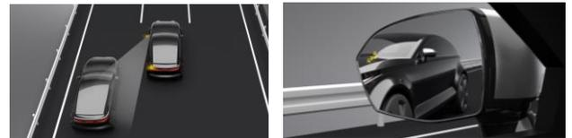
従来はミラー頭部に鏡面作動させるためのアクチュエーターを内蔵する必要があり、ある程度のスペースを確保しなければならずミラー頭部の小型化が困難でした。今回のコンセプトは電動格納アクチュエーターと統合することにより小型化による意匠性と空力性能の向上が可能となります。
