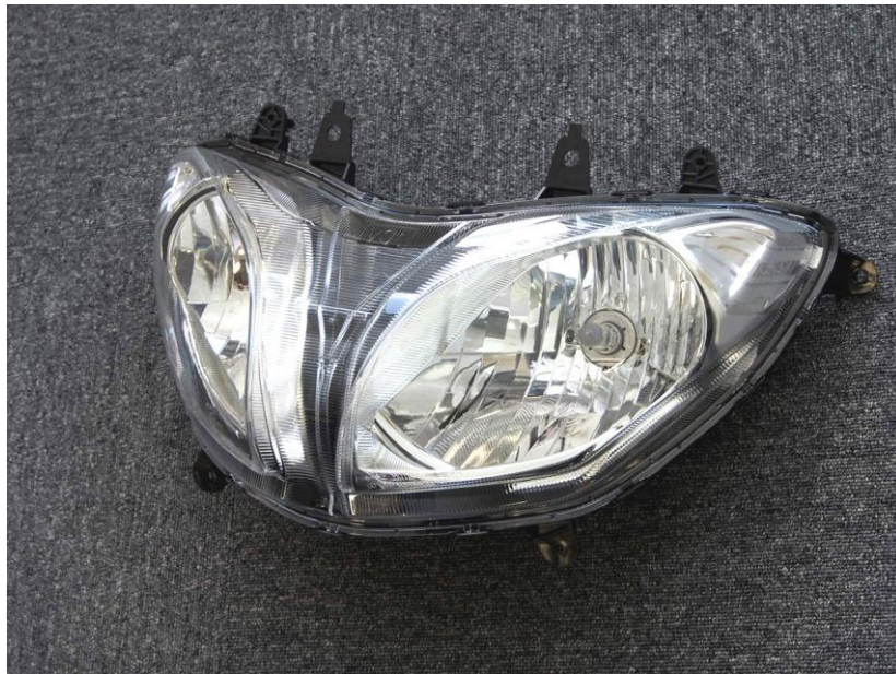
スズキ「スカイウェイブ 650LX」に搭載される市光工業のリフレクター式ヘッドランプ
