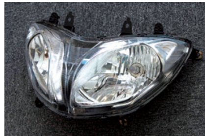
スリムなりフレクター方式のヘッドランプユニット
