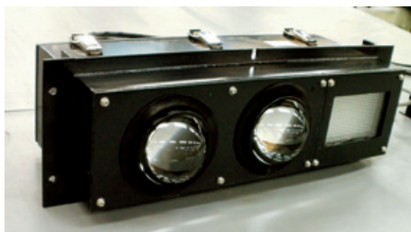
HIDプロジェクターユニットが搭載された前照灯
