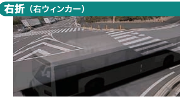
右折（右ウインカー） 右ウインカーと連動 右折時だけでなく、車線変更時や側道からの合流時にも効果的
