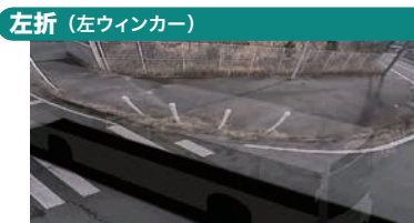
左折（左ウインカー） 左ウインカーと連動 バイク・自転車・歩行者との接触事故防止
