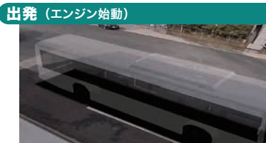
出発（エンジン始動） 出発前の車両周囲確認 ACC-ON時に360°確認できるビューが自動で起動
