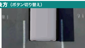
後方（ボタン切り替え） 後退時での俯瞰後方アップビュー 後方カメラだけではわかりにくい車両後方の角も俯瞰ビューで確認 ※
