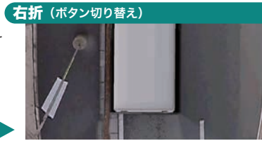
右折（ボタン切り替え） 発進時での後方俯瞰ビュー バス停などからの発進時、バス停やガードレールなどに後方角がぶつからないように確認可能 ※
