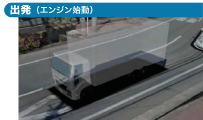
出発（エンジン始動） 出発前の車両周囲確認 ACC-ON時に360°確認できるビューが自動で起動
