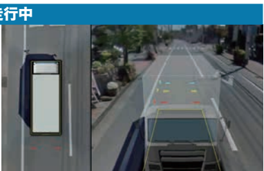
走行中 走行中に表示されるビュー 交差点時での巻き込み、車線変更前に左右・後方も確認可能
